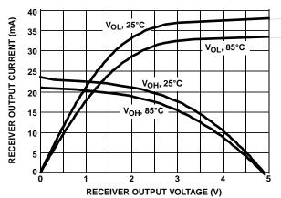
FIGURE 24. RECEIVER OUTPUT CURRENT VS RECEIVER OUTPUT VOLTAGE
